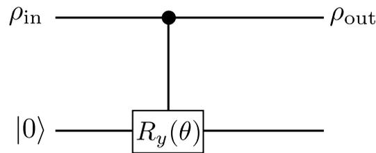
Abbildung 1: Darstellung einer Quantenschaltung für die Phasen-Dämpfung mit einer bedingten Rotation um  $y$ -Achse auf der Bloch-Kugel. Die obere Linie beschreibt das Control-Qubit (das System) und die untere Linie beschreibt das Target-Qubit (die Umgebung), das am Anfang den Zustand  $|0\rangle$  hat.
